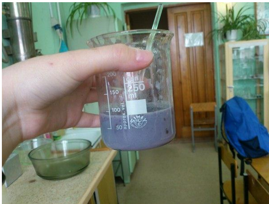
Рисунок 2. а) постепенный переход белого раствора азотнокислой соли тетрадециламина в фиолетовый, б) постепенный переход белого раствора в фиолетовый
