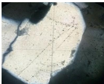
Рисунок 1. Шлиф-1868 Газово-жидкие включения в кварце (диаметр поля зрения 0,25 мм)
