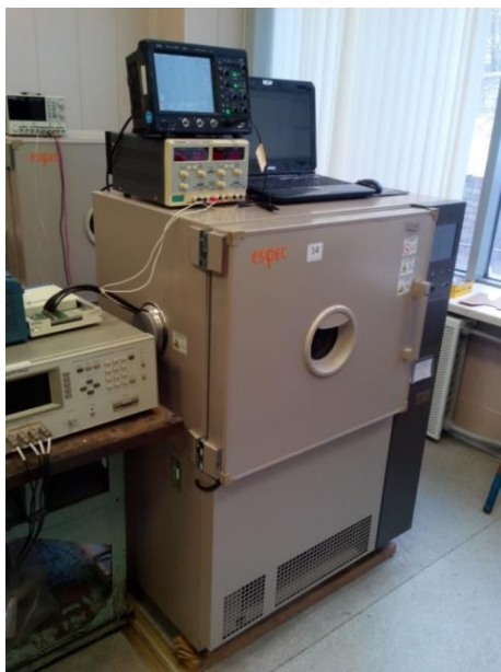
Рисунок 2. Камера тепла-холода Espes MC-811P
