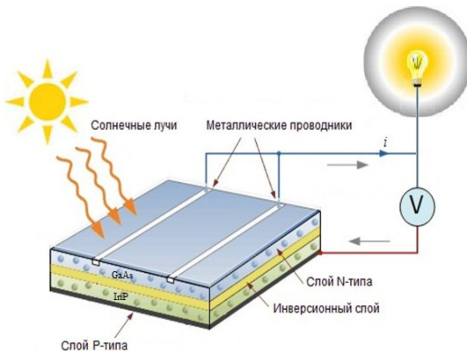
Рисунок 1. Структура солнечного элемента на основе гетероперехода InP – GaAs
