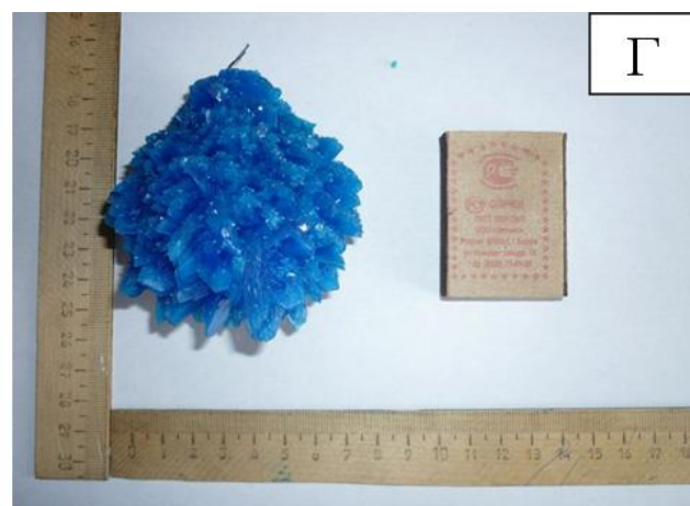
Рисунок 2. Форма и размеры кристаллов \text{CuSO}_4 \cdot 5\text{H}_2\text{O} : В-3 (В) — неправильное скопление друз; В-4 (Г) — круглая елочка
