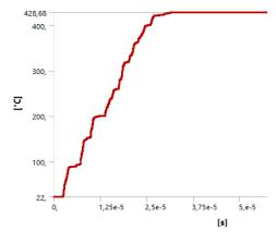
Рисунок 11. Температура сферической поверхности ударника
