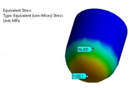
Рисунок 5. Эквивалентные напряжения в ударнике
