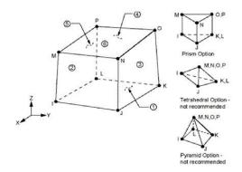
Рисунок 3. Схема конечного восьми узлового элемента
