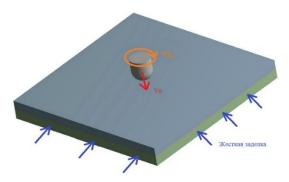
Рисунок 2. Скорости, действующие на ударник, закрепление плиты
