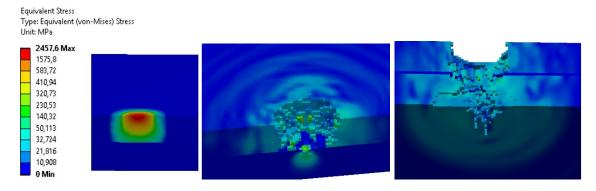
Рисунок 4. Эквивалентные напряжения в плите, при разной глубине проникновения ударника
