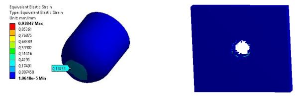
Рисунок 9. Пластические деформации в ударнике после пробития и форма разрушения плиты
