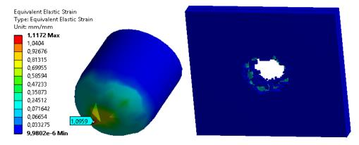
Рисунок 12. Пластические деформации в ударнике после пробития и форма разрушения плиты
