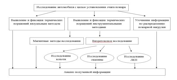
Рисунок 3. Основные этапы исследования пожаров на легковых автомобилях с целью установления очага пожара
