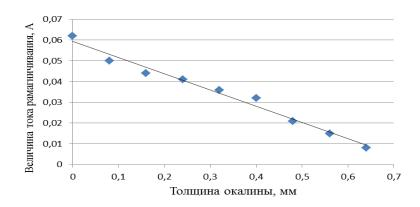
Рисунок 1. Изменения величины тока размагничивания в зависимости от толщины окалины
