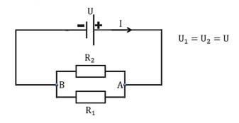
Рисунок 2. Параллельное соединение (схема)
