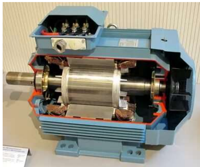
Рисунок 3. Внешне строение двигателя переменного тока и строение в разрезе
