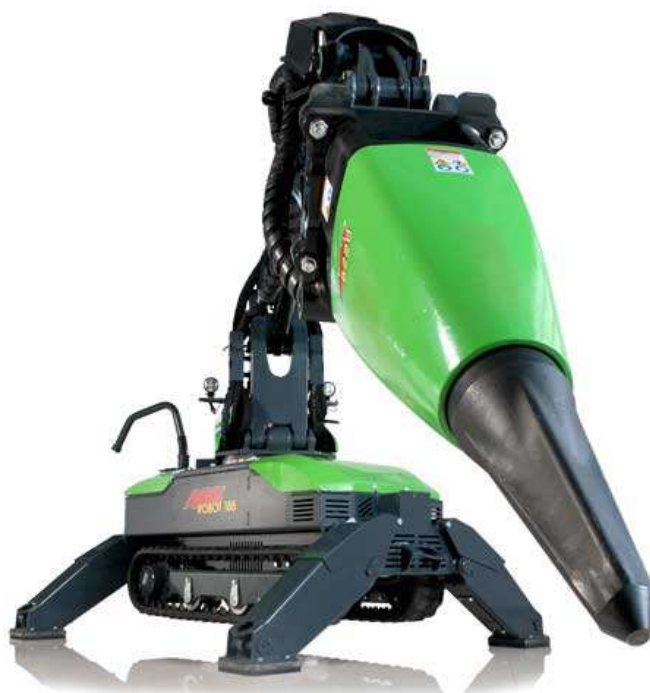
Рисунок 3. Демонтажный робот Avant 185
