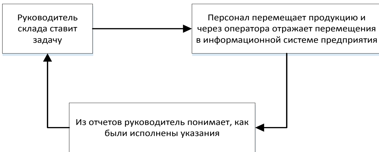
Рисунок 1. Процесс функционирования склада без WMS-системы
