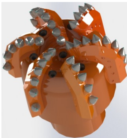
Рисунок 9. Лопастной буровой инструмент с поворотными резцами
