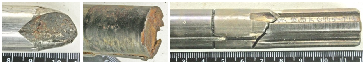
Рисунок 2. Разрушение валов ЭЦН
