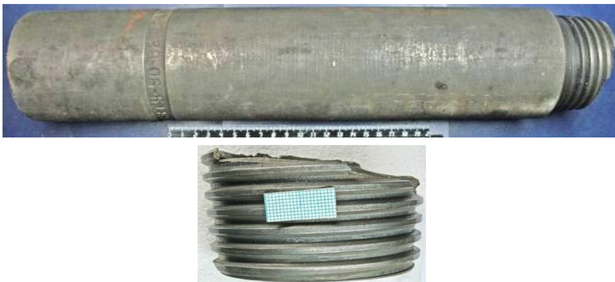
Рисунок 1. Разрушение переходников замка ЗТУ 90-62 3-80
