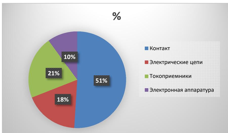
**Рисунок 5. Отказы электрических аппаратов электровозов**
