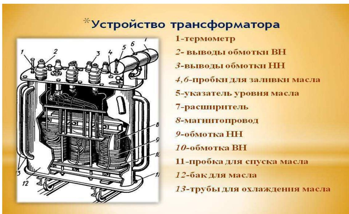
*Рисунок 1. Устройство трансформатора*
