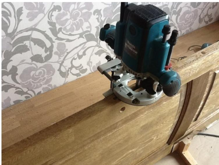
***Рисунок 1. Вырезание углубления под установку фурнитуры в «ручном» режиме в полотне двери с помощью ручного фрезера. Полотно двери установлено и зафиксировано вертикально***
