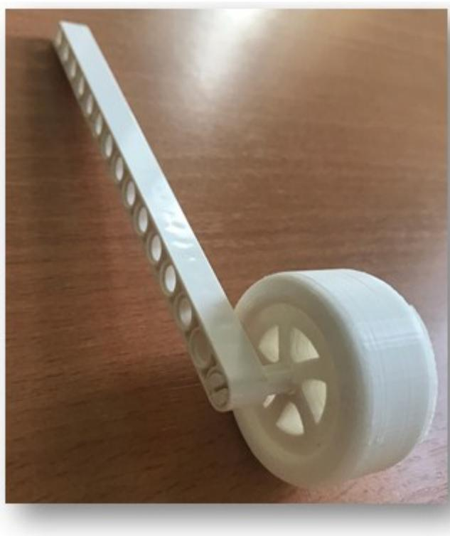
***Рисунок 1. Распечатанное на 3D-принтере новое колесо, созданное в Autodesk Tinkercad***
