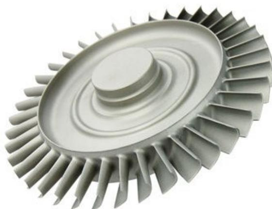
*Рисунок 1. Заготовка рабочего колеса, полученная методом литья по выплавляемым моделям*
