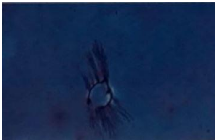
Рисунок 1. Водный триинг, развивающийся от подковообразного загрязняющего включения
