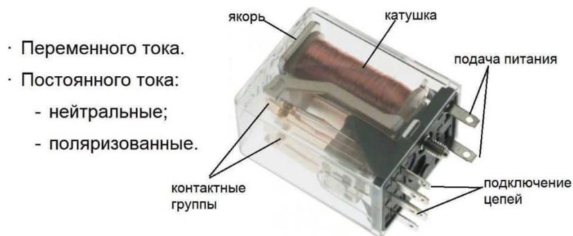
Виды электромагнитных реле по типу питающего напряжения и внешний вид одной из моделей
