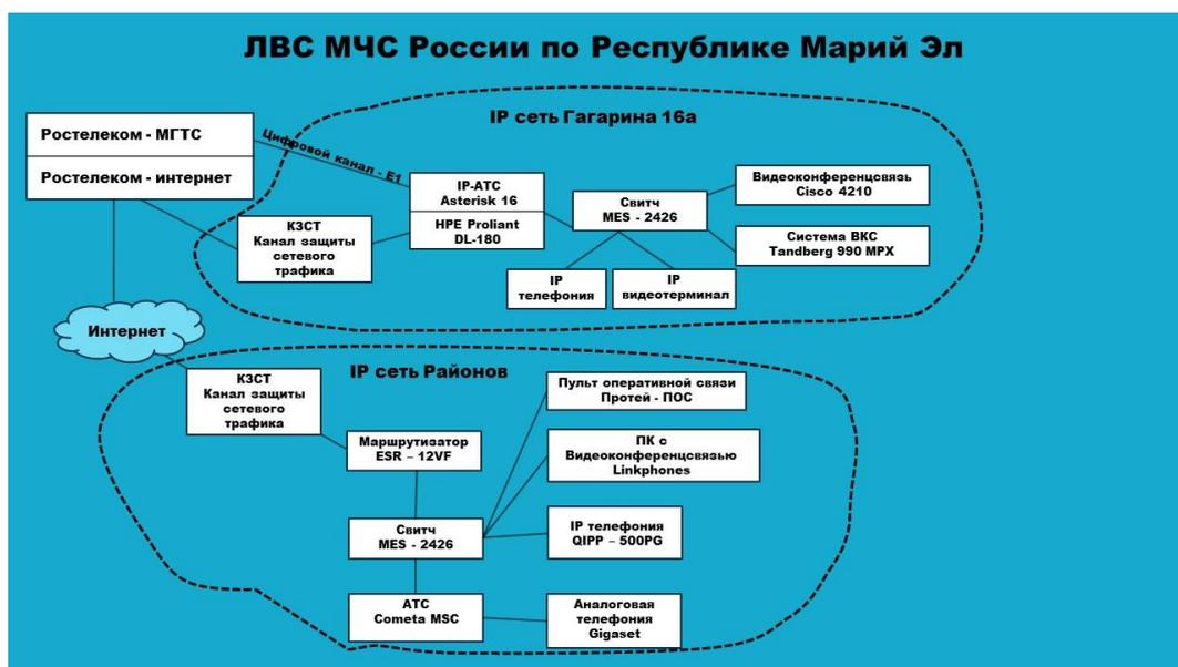
**Рисунок 3. Логическая схема разрабатываемой вычислительной сети**
