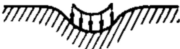
***Рисунок. 2. Характер деформации грунта по модели упругого полупространства***
