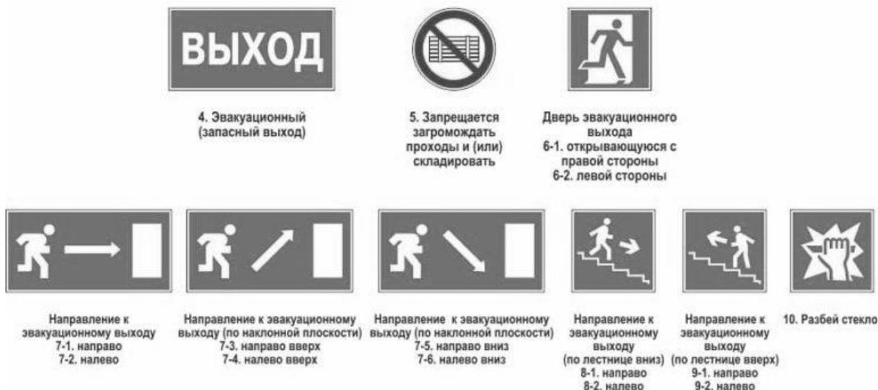
**Рисунок 1. Знаки пожарной безопасности, используемые для обозначения путей эвакуации и эвакуационных выходов**
