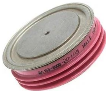
Рисунок 1. Мощный силовой лавинный диод ДЛ153-2000, внешний вид
