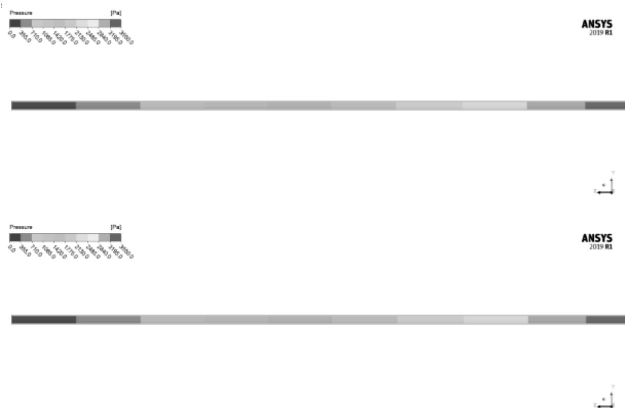
Рисунок 10. Контурный график статического давления по продольному сечению трубы в ANSYS 19.1
