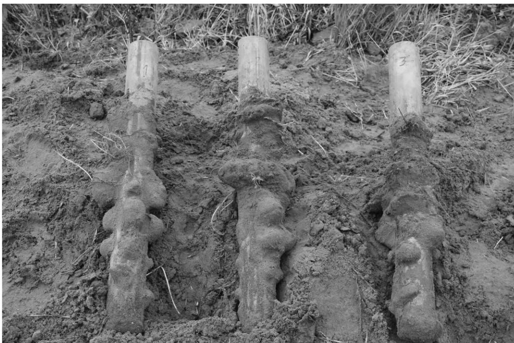
**Рисунок 5. Опытные образцы свай после эксперимента**
