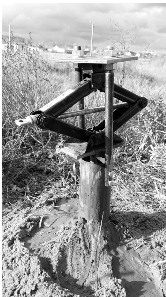
**Рисунок 4. Нагнетательное устройство в сборе**
