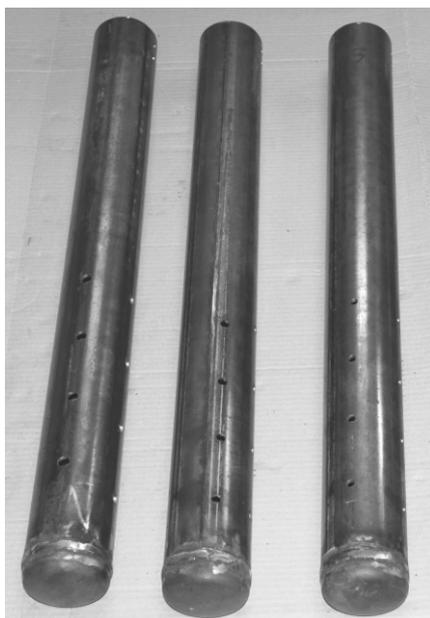
**Рисунок 2. Опытные образцы свай**
