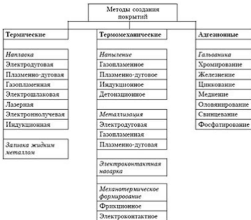
**Рисунок 1. Классификация методов нанесения покрытий**
