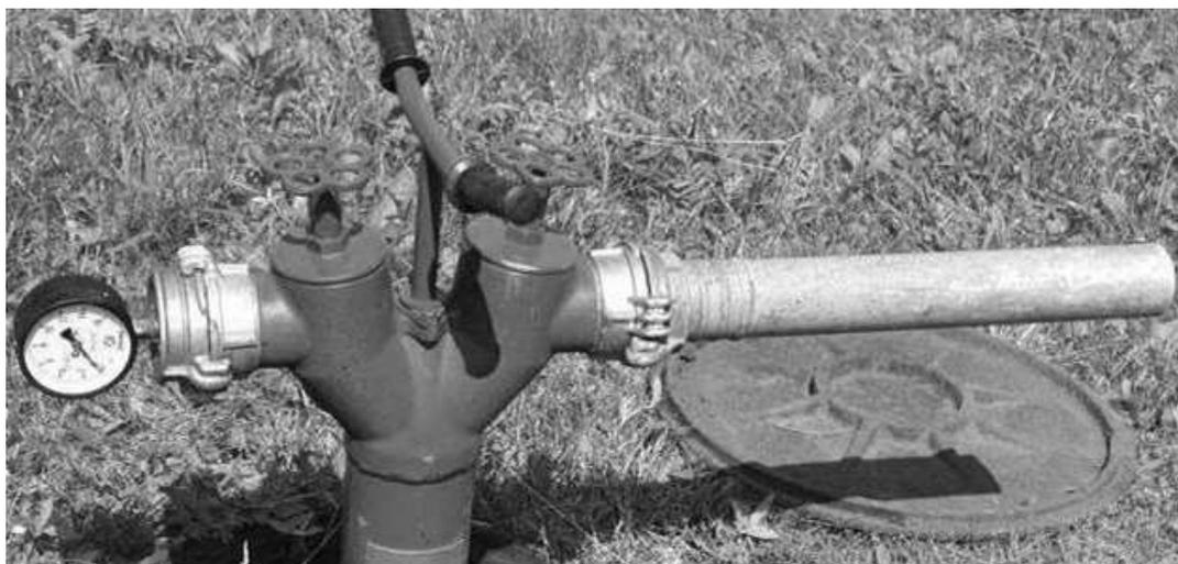
**Рисунок 3. Готовый к испытаниям пожарный гидрант**
