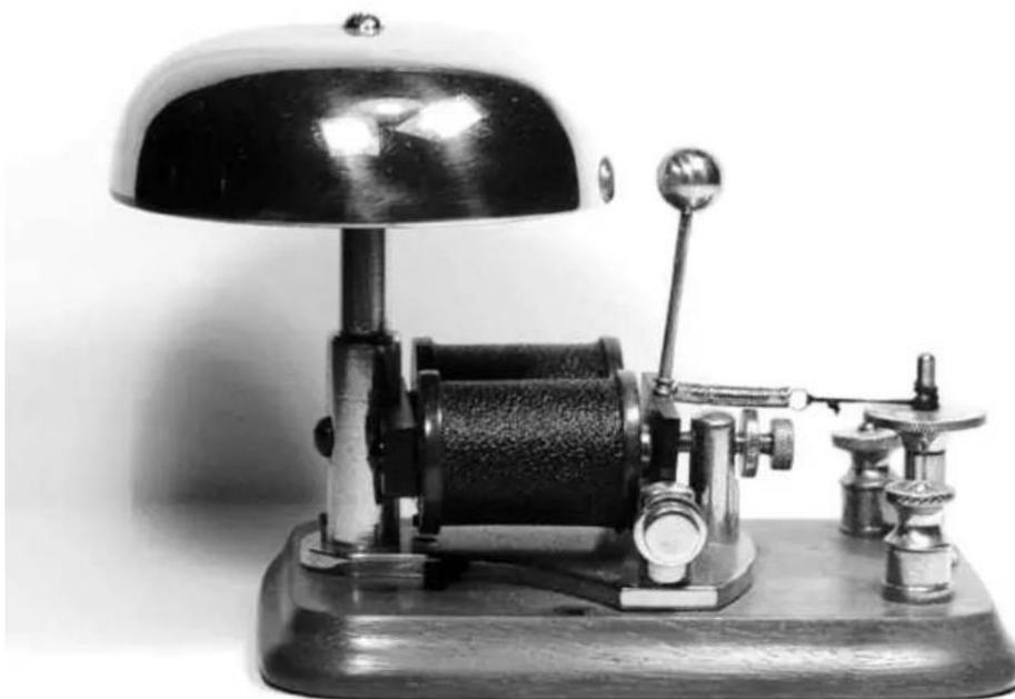
*Рисунок 1. Реле с одним воздушным зазором*
