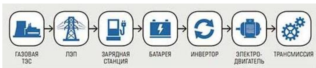
Рисунок 1. Элементы цепи снабжения энергией колес электромобиля
