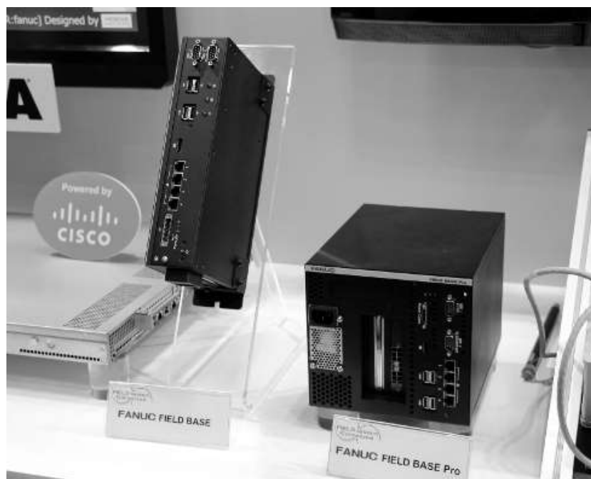
Рисунок 1. Аппаратное обеспечение системы FIELD; от 30 до 150 одновременно подключенных устройств
