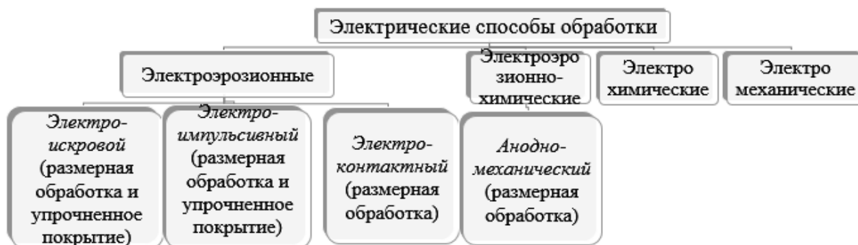
Рисунок 1. Общая классификация электроэрозионных способов обработки металлов
