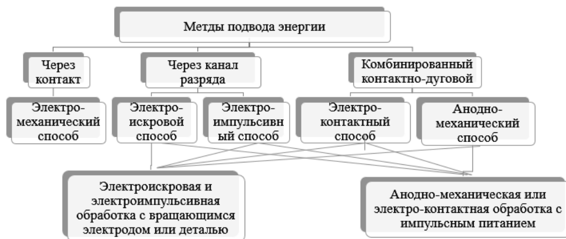
Рисунок 2. Распределение методов обработки металлов по способам подвода энергии
