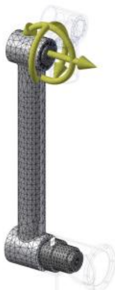
Рисунок 1. Каркасная модель 3-его звена манипулятора ARM165 для расчета механических нагрузок
