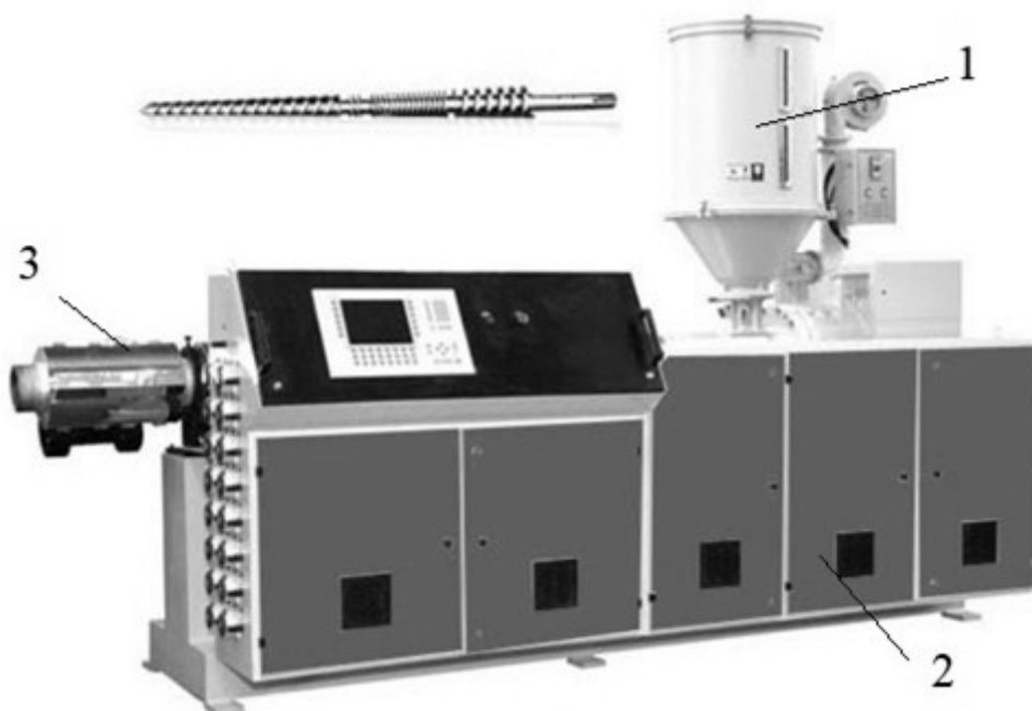
Рисунок 2. Технологическая линия производства полиэтиленовых труб: 1 – загрузочный бункер-осушитель; 2 – шкаф управления производственной линией; 3 – одношнековый экструдер КМЕ65
