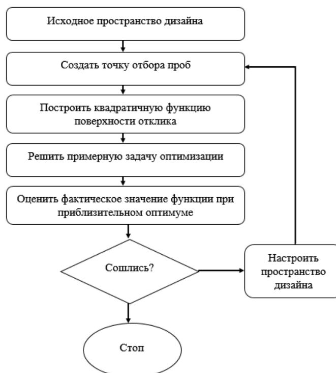
Рисунок 1. Блок-схема процесса оптимизации PQRSM
