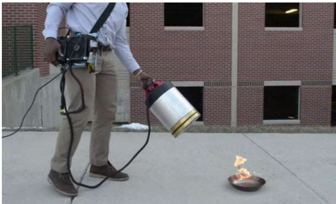
Рисунок 1. Применение звукового огнетушителя для тушения пламени
