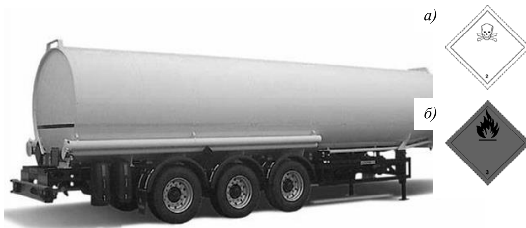
а) маркировка сжиженного углеводородного газа; б) маркировка бензина и дизельного топлива.
