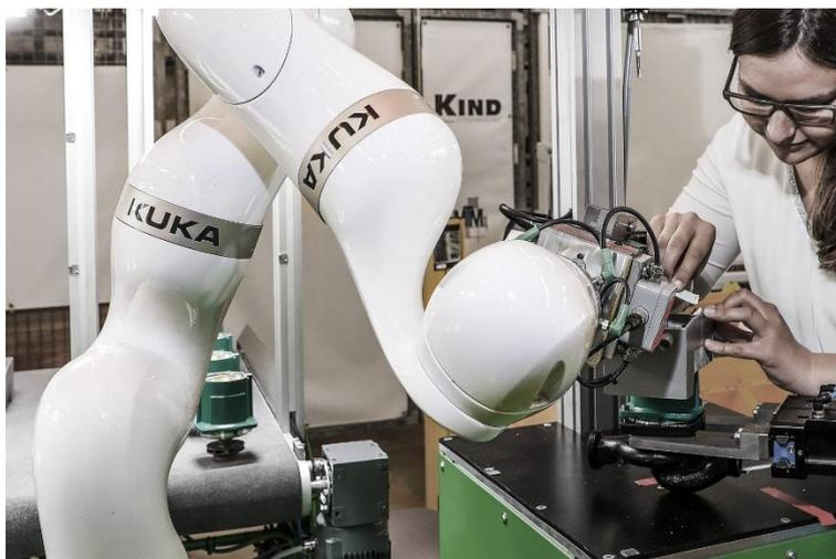
**Рисунок 4. Совместное выполнение сборочно-монтажных операций с помощью МИСП**
