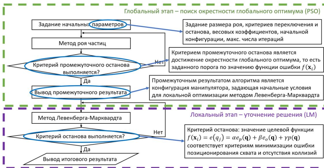
Рисунок 6. Схема комбинированного алгоритмического решения
