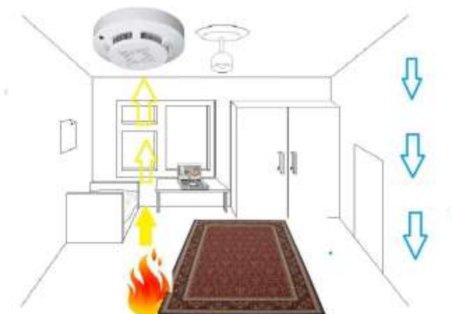
Рисунок 1. Принцип действия пожарного извещателя
