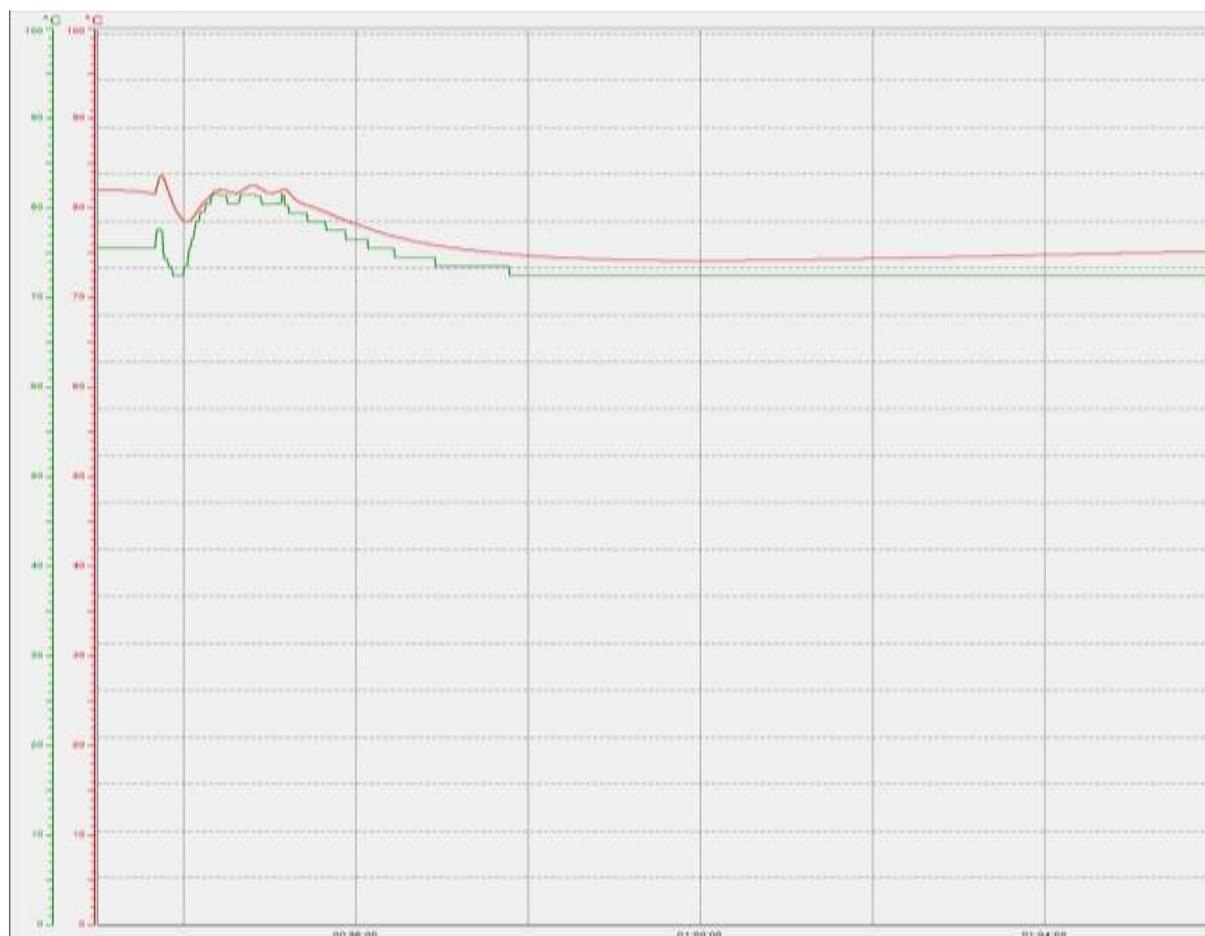
**Рисунок 3. Изменение температуры на входе (зеленый) и на выходе (красный) из двигателя при уменьшении скорости с 16,6 км/ч до 3,7 км/ч**
