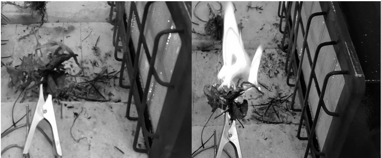
Рисунок 2. Кадры видеосъемки процесса зажигания ЛГМ (слой листьев) сфокусированным инфракрасным излучением при интенсивности теплового излучения 11700 \text{ Вт/м}^2 : а) t=0 сек – начальный вид слоя; б) t=10 сек – термическое разложение; в) t=30 сек – образование очага тления; г) t=40 сек – зажигание в газовой фазе;
