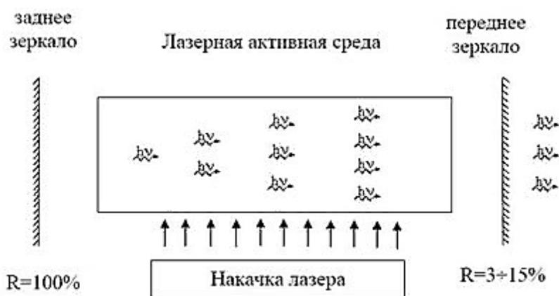
**Рисунок 5. Устройство резонатора**
