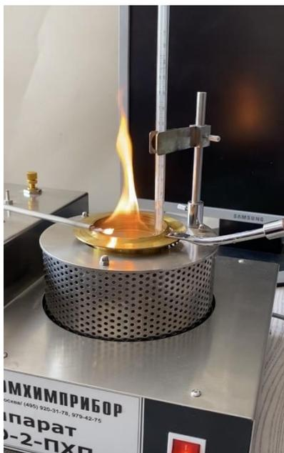
*Рисунок 2. Температура вспышки смеси изопропилового спирта и керосина*
