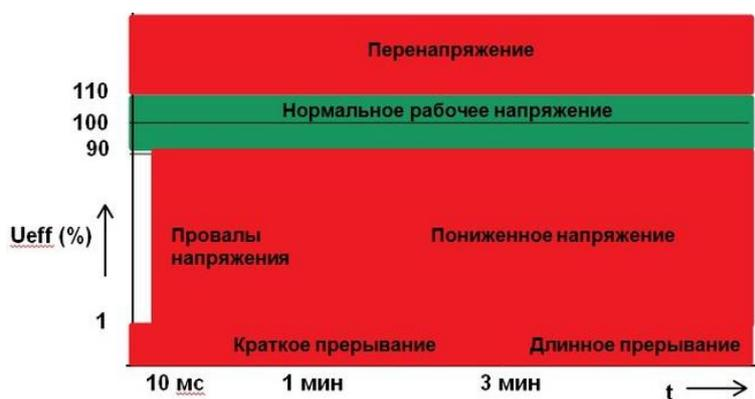
Рисунок 2. Разница между провалом, прерыванием и пониженным напряжением
