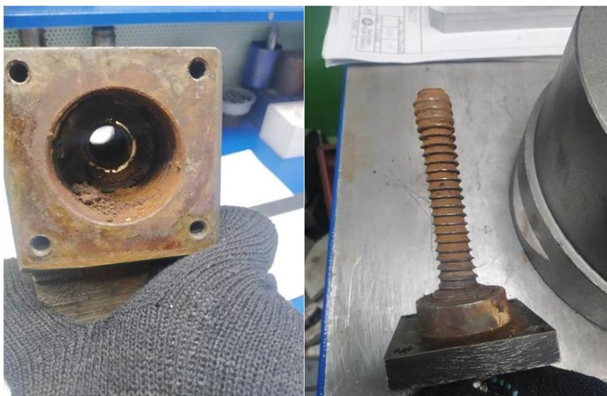
**Рисунок 2. Коррозия и износ рабочих поверхностей**
