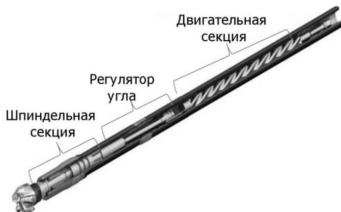
Рисунок 2. Схема ВЗД
