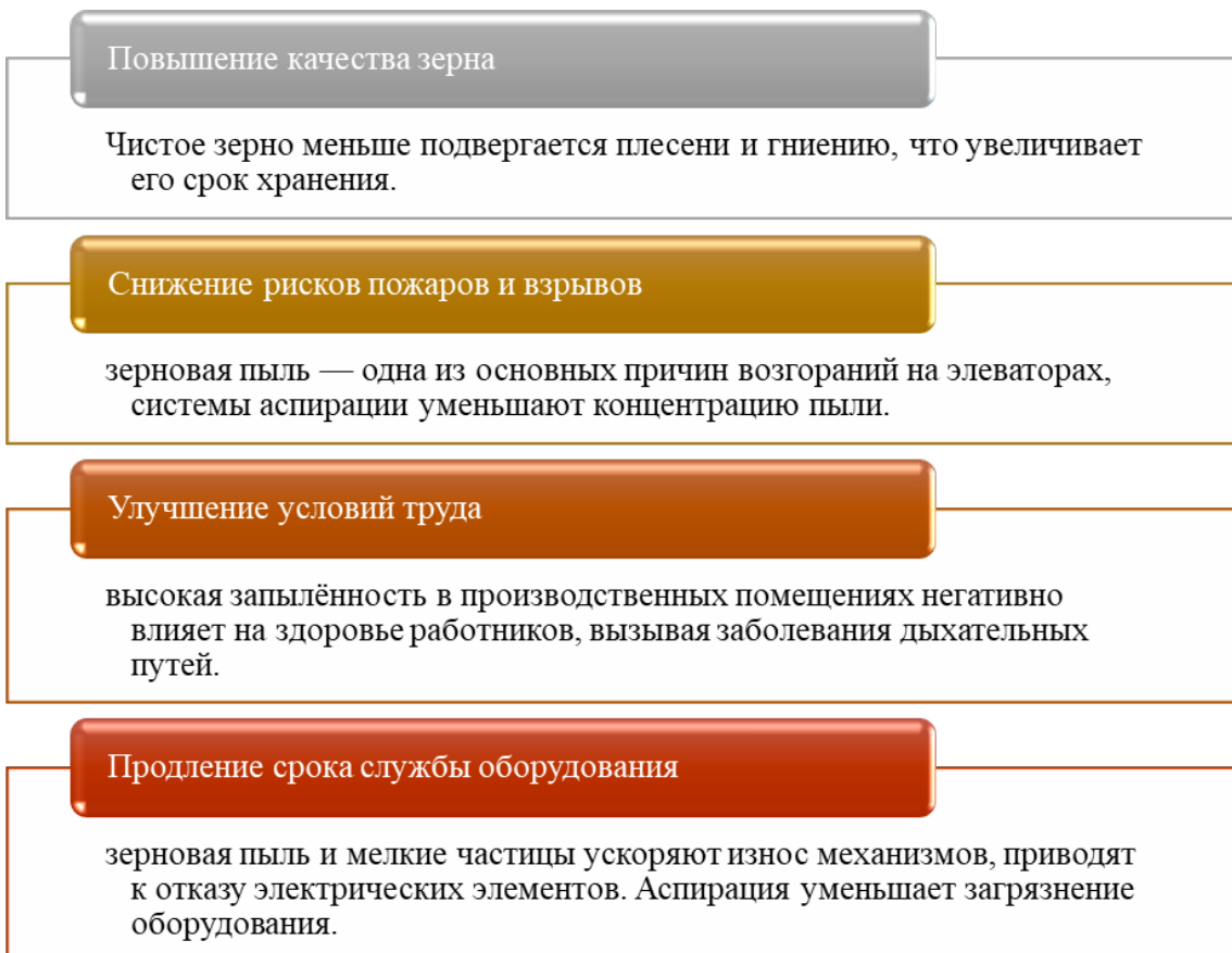
Рисунок 2. Функции аспирационных систем
