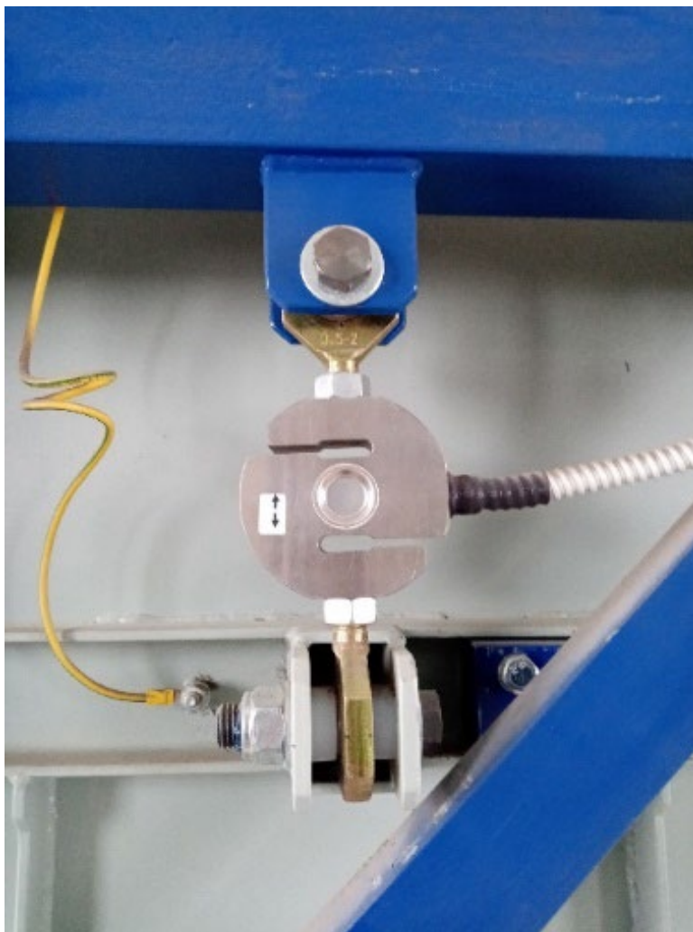
Рисунок 2. Силоизмерительное устройство – тензодатчик
