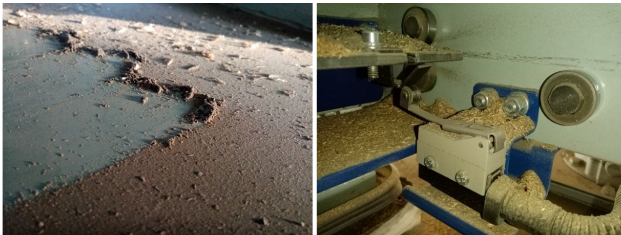
Рисунок 1. Результат плохо работающей аспирации
