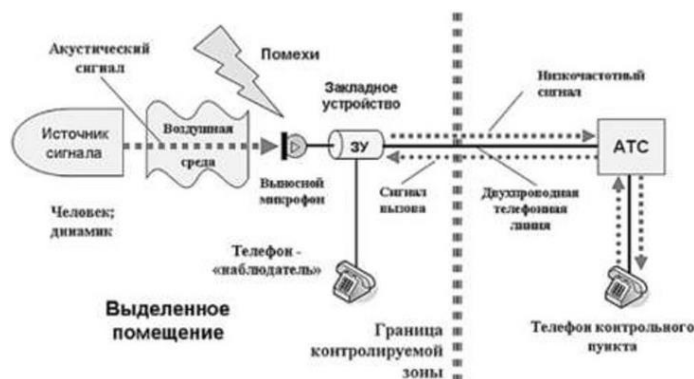
Рисунок 1. Схема канала перехвата речевой информации с использованием устройств типа «телефонного уха» с передачей информации по телефонной линии на низкой частоте
