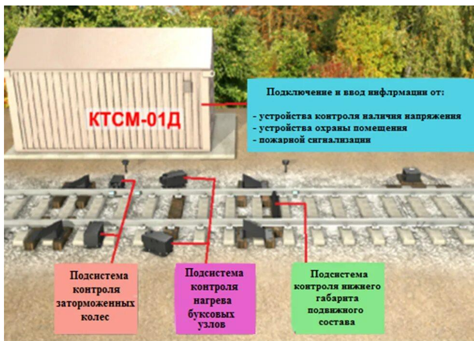
Рисунок 1. Напольное оборудование КТСМ
