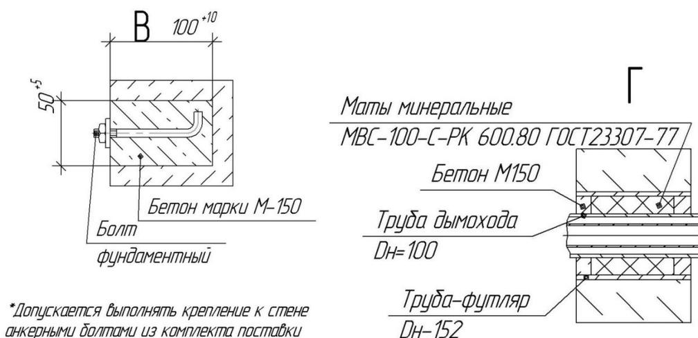
**Рисунок 2. Схема установки настенного газового отопительного котла (размеры в мм).**
