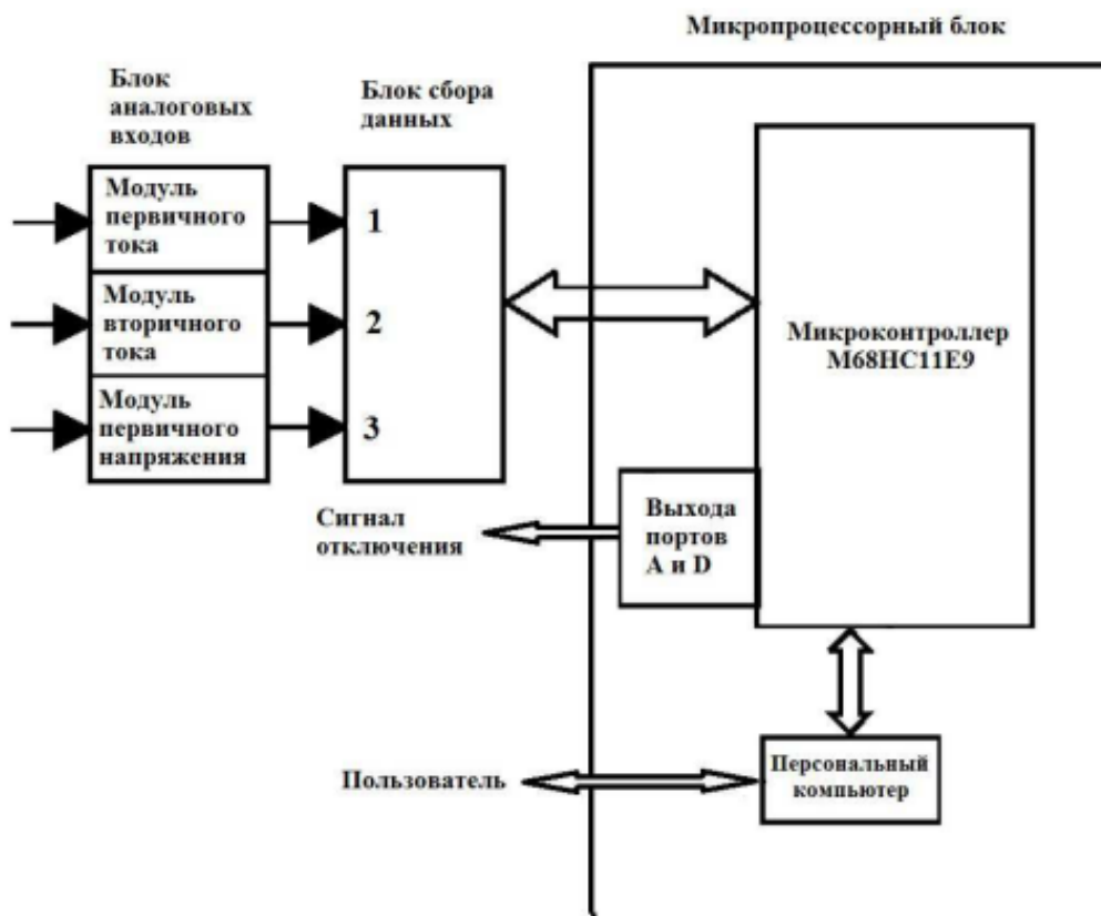
Рисунок 1. Схема микропроцессорной релейной защиты
