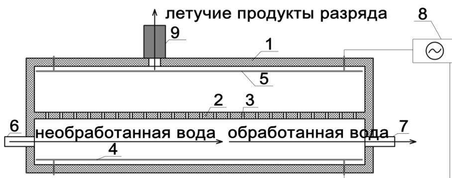
**Рисунок 2. Непроточный реактор обработки воды**
