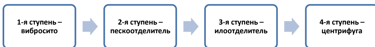
Рисунок 1. Ступени четырехступенчатой системы очистки БР
