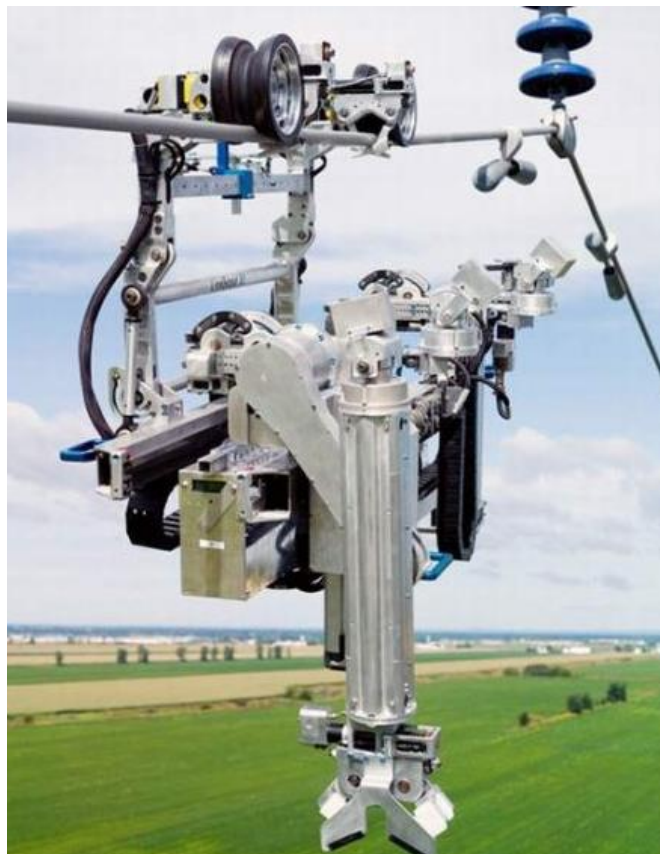
Рисунок 2. Робот LineScout на проводе ЛЭП
