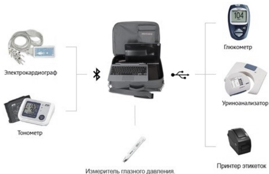
Рисунок 1. Состав мобильного медицинского диагностического комплекса
