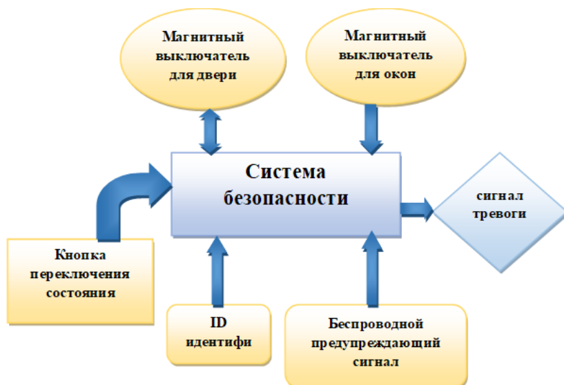
Рисунок 1. Структурная схема домашней системы безопасности
