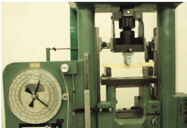
*Рисунок 5. Устройство определения модуля упругости Юнга*
