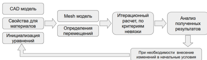
Рисунок 2. Схема САЕ моделирования
